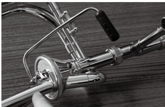
新しく特許を取得したアクシャル・フロー・バルブ。ゲースネック(指さしている)が真っ直ぐに出ている。バルブのボトムにはベアリングが装着され、スムーズな回転と高い密閉性を実現、メンテナンスも容易にした。
