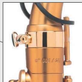
ネックレシーバーには限定 モデルのみに記される製造 番号が刻印されています。 洋白製のソケットリング、真 鍮製のスクリューは金メッキ で仕上げられています。
